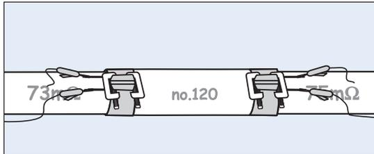
20. Die Endspannung der Schweißmaschine für jedes Band laut den aktuellen Schweißparametern einstellen. Schweißklemmen äußerst an den Terminaldrähten befestigen. Schweißprozess anfangen. Nach Schweißung warten, bis die Muffe abgekühlt ist (handwarm), min. 30 Minuten. Die Spannbänder erst entfernen, wenn die Unterseite der Spannbänder abgekühlt ist (handwarm).
