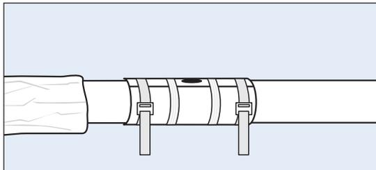
6. Die Aluminiumhülle mitten auf dem Verbindungsbereich anbringen. Die Bandspanner spannen. Filamentklebeband rund um die Hülle auf beide Seiten des Loches wickeln.
