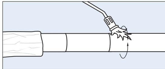
10. Mantelrohre mindestens 150 mm von beiden Rohrenden mit Gasbrenner aktivieren, bis die Oberfläche seidig glänzt.
