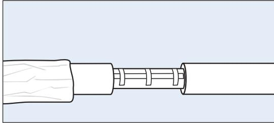
5. Die Mineralwollschalen stramm um das Mediumrohr montieren. Die Verbindung mit Klebeband dichten.
