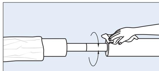
3. Alle Oberflächen der Verbindung reinigen.
