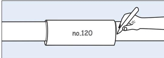
13. Die Verpackung der Schrumpfmuffe entfernen. Keine scharfen Werkzeuge anwenden. Die Verpackung auf der Rohrleitung bleiben lassen. Sicherstellen, daß die Muffe außen und innen SAUBER und TROCKEN ist. Die Muffe mitten auf der Verbindung anbringen. Beide Muffenenden auf den Mantelrohren markieren. Die Nummer der Muffe auf die Muffe schreiben. Das Dokumentationsformular ausfüllen.
