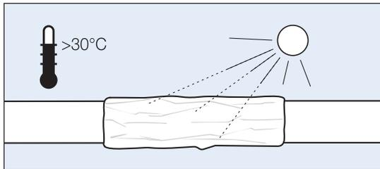
Falls die Umgebungstemperatur >30° ist oder die Schrumpfmuffe dem Sonnenlicht ausgesetzt ist, muss die Folienverpackung auf der Rohrleitung verbleiben, bis die Schrumpfmuffe geschrumpft ist. Die Schrumpfmuffe mit der Einpackfolie abdecken, wenn an der Verbindung nicht gearbeitet wird.
