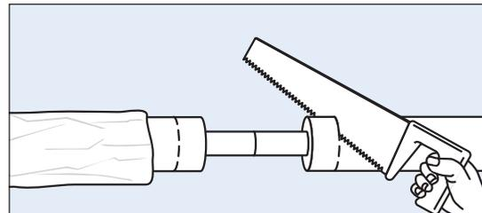
2. Den äussersten Teil den Mantelrohre bei der Markierung abschneiden.
