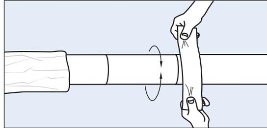
9. Min. 30 Minuten nach Entgasung warten. Die Aluminiumhülle entfernen. Mantelrohre mindestens 150 mm von beiden Rohrenden mit Schmirgelleinen, Körnung 80, schleifen.
