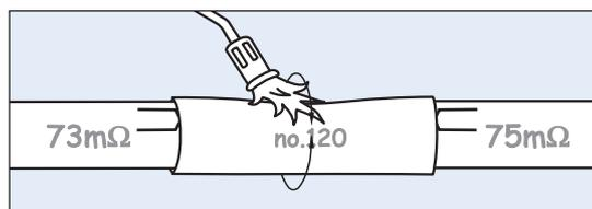
18. Die Muffe von der Mitte gegen die Enden schrumpfen. Schrumpfen, bis die Muffe vollständig in Kontakt mit den Schweißbändern, der Dämmung und dem Mantel ist.
