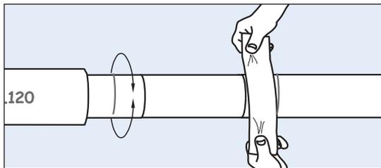
14. Die Muffe vom gereinigten Ende wegschieben. Die Mantelrohre gründlich mit Schmirgelleinen, Körnung 36-40, schleifen, so daß die Markierungen eben berührt werden.
