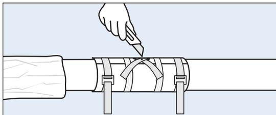
8. Die Öffnung mit Leinenklebeband dichten. Das Klebeband für Entlüftung anschneiden.
