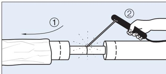
1. Schrumpfmuffe mit Verpackung auf eines der Rohre aufschieben, bevor die Mediumrohre miteinander verbunden werden.
