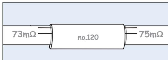
17. Die Muffe zwischen den Markierungen anbringen. Die Schaumlöcher nach oben wenden. Nummern und Widerstandswerte auf die Muffen/Mantelrohre und in das Dokumentationsformular notieren.
