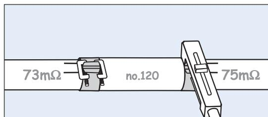
19. Spannbänder 5-10 mm über die Muffenenden hinaus montieren. Genau bis zur Verformung des Mantels spannen (max. 0,1 mm). Die eingespannten Spannbänder mit einer Spannvorrichtung festhalten.
