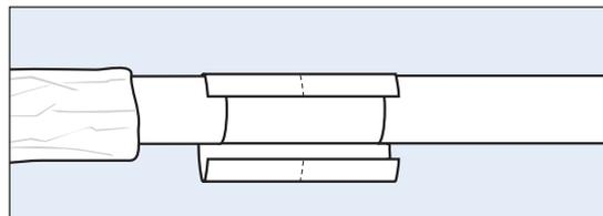
11. Schrumpffolie so anbringen, daß der Markierungsstrich um das Rohr herumläuft. Eine ihrer Kanten in „10-Uhr-Position“ befestigen. Schrumpffolie um das Rohr durch Abziehen des Schutzpapiers herumführen, so daß die Folie an der darunter liegenden Oberfläche anliegt.
