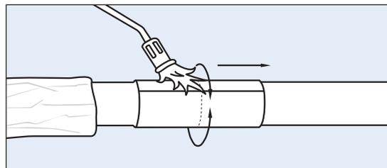
12. Die Folie von der Mitte gegen beide Seiten erwärmen, bis die Dichtungsmasse an alle Kanten heraustritt und die Folie um das Rohr stramm liegt.
