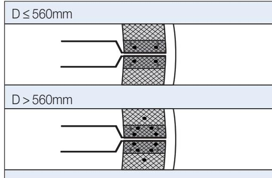
16. Schweißbänder mit Nägeln befestigen, wie illustriert, und mit einem Nagel ca. jede 250 mm um die Mantelrohre herum.
