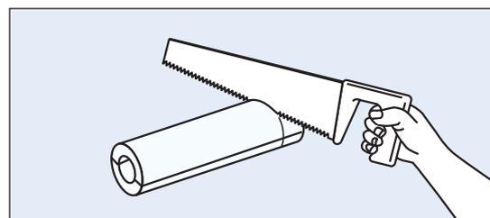
4. Mineralwollschalen kürzen, so daß sie stramm zwischen den Mantelrohrenden passen.
